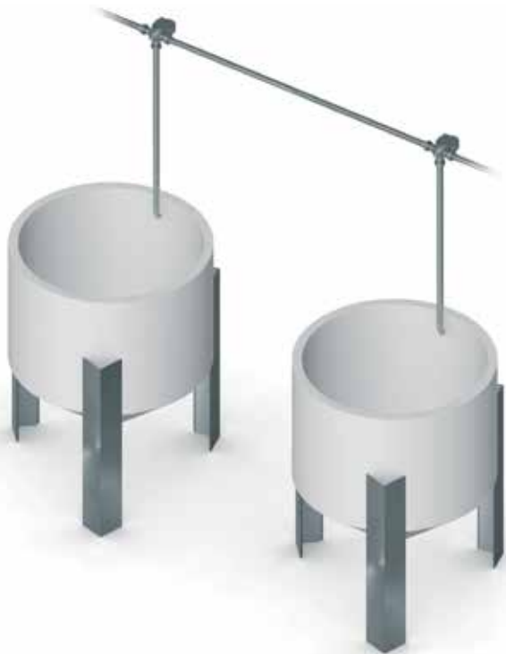
Distribuzione monolinea con impiego di valvole a tre vie.
