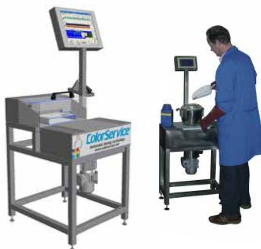
Rappresenta il primo livello d'automazione per la pesatura dei coloranti in polvere. Nel computer in dotazione risiede il programma di pesatura, nel caso di rete aziendale questo può essere inviato dal sistema di programmazione centralizzato.
