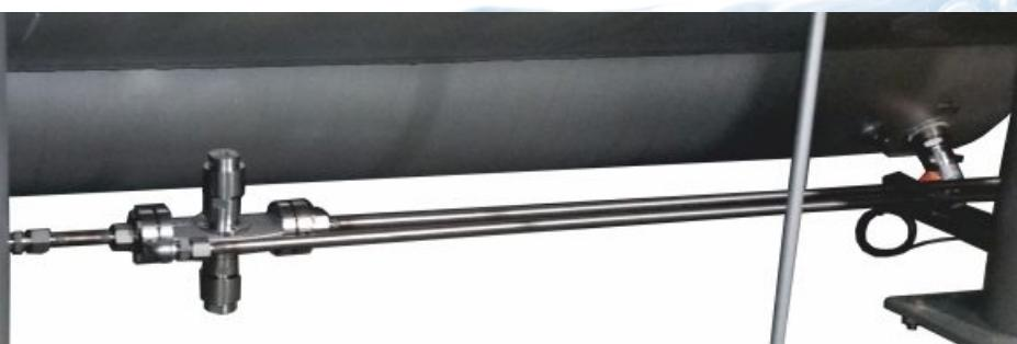
**IWS (intelligent washing system)** è un sensore di analisi del bagno all'interno del corpo macchina che permette di sapere in ogni momento il grado di pulizia/sporcamento del bagno.
