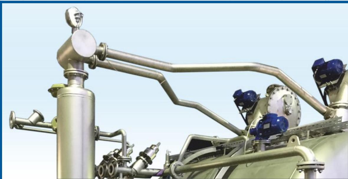
Il distributore del bagno, garantisce che ad ogni ugello arrivi la medesima portata di bagno. All'interno del collettore è inserito uno speciale diffusore che permette una perfetta divisione delle portate in proporzione al numero di tronchetti/ugelli presenti sulla macchina (patent pending).
