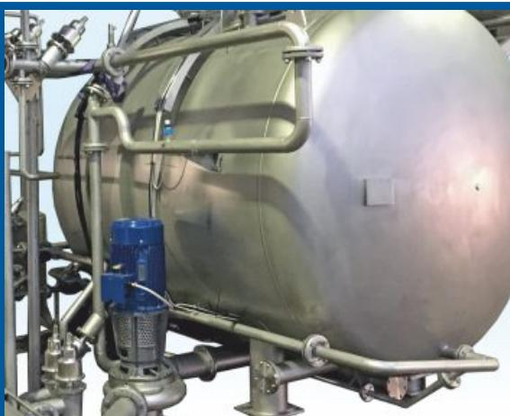
L'ugello a sezione variabile, unitamente al sistema di faldatura idraulico e alla particolare conformazione del cesto di contenimento del tessuto, garantiscono l'ottimale circolazione del tessuto sia estremamente leggero che pesante. Questo fa sì che la DANIFLOW sia una macchina estremamente versatile e semplice da utilizzare per l'operatore.
