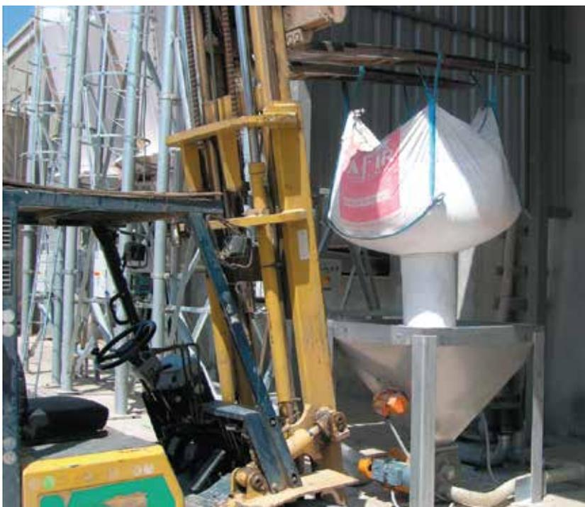
Carico con pompa pneumatica stellare (capacità di carico 5 tons/ora) da big bag o da sacchi. Il sistema è dotato di tramoggia di scarico prodotto.
