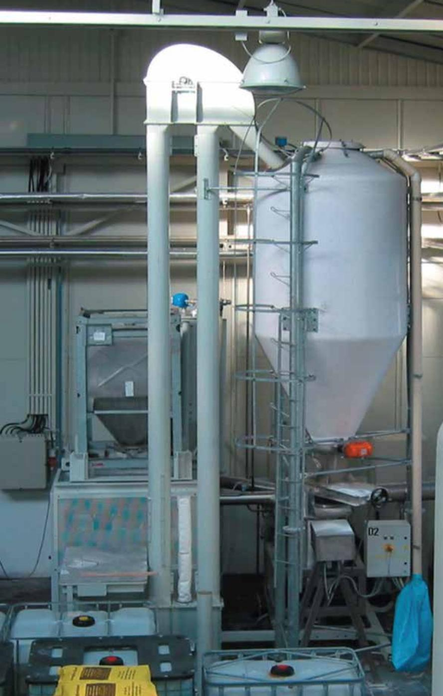
Carico con caricature a tazze realizzato in acciaio Inox e tazze in PVC speciale resistente all'abrasione. Velocità di carico 10 tons/ora. È provvisto di tramoggia di carico prodotto 100/150 kg di capacità.
