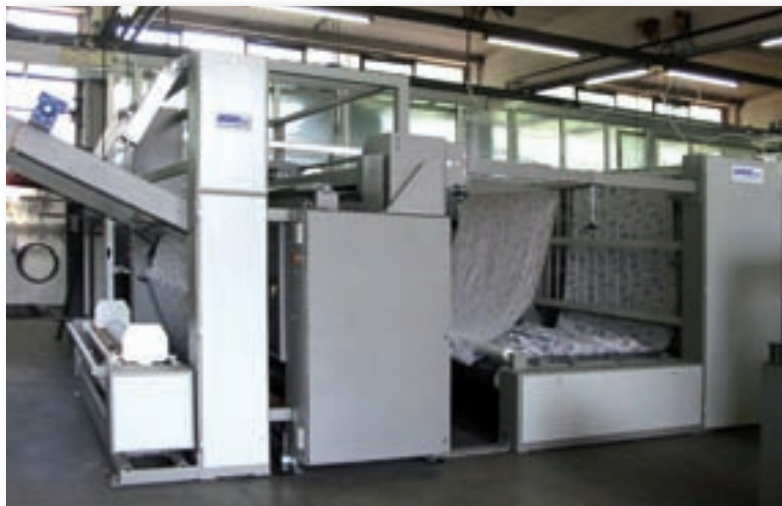
Mod. 1090-WS Impianto preparazione tessuti delicati con doppia uscita e raddrizzatrama Mod. 1090-WS LIGHT fabrics preparation line with DOUBLE exit and weft straightener
