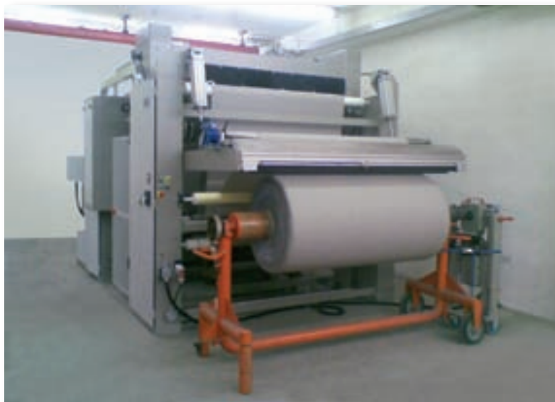
Mod. 1090-CY Impianto preparazione tessuti per camicie con arrotolamento assiale Mod. 1090-CY Grey preparation line for shirting fabrics with axial driven uprolling group
