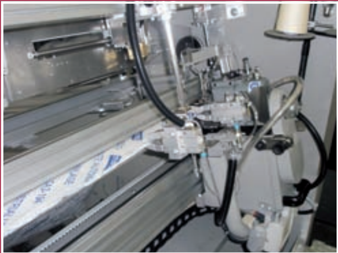
Introduzione automatico tessuto alla macchina da cucire e dispositivi di srotolamento testane arrotolate Automatic system for the fabric placement in the sewing machine and uncurling device for curled heads
