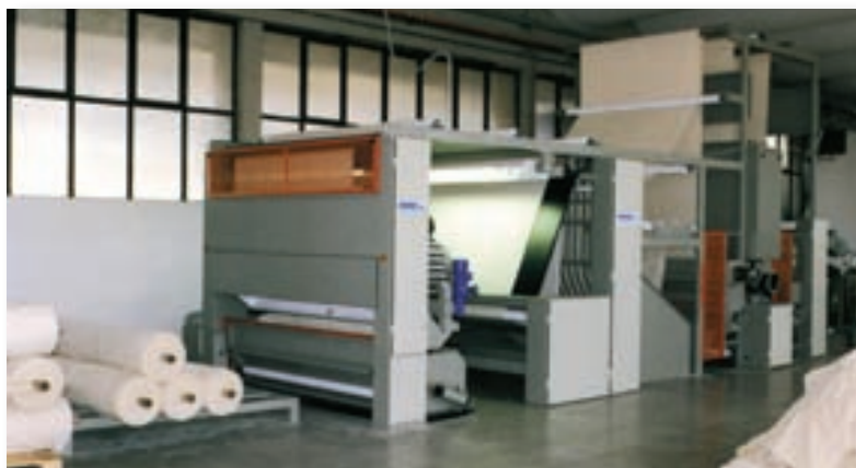
Mod. 1090-IT Impianto preparazione tessuti greggi con tavola di ispezione e verifica Mod. 1090-IT Grey fabrics preparation line with inspection table
