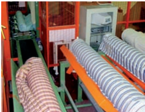
Mod. 1090-T Sistema automatico trasporto rotoli a linea di produzione Mod. 1090-T Automatic rolls transportation to the production line
